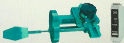
شکل ۲: کنترلر و شاتر طراحی شده و ساخته شده برای سل آرسنیک.
