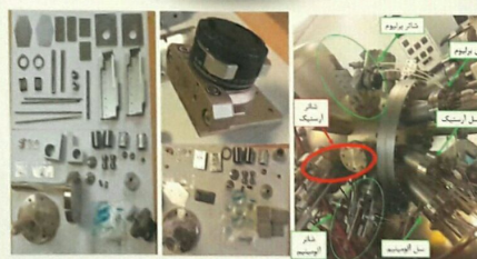
شکل ۱: سمت راست مکان خالی شاتر سل آرسنیک بر روی دستگاه و ۲ تصویر سمت چپ قطعه های طراحی شده شاتر قبل از نصب.
